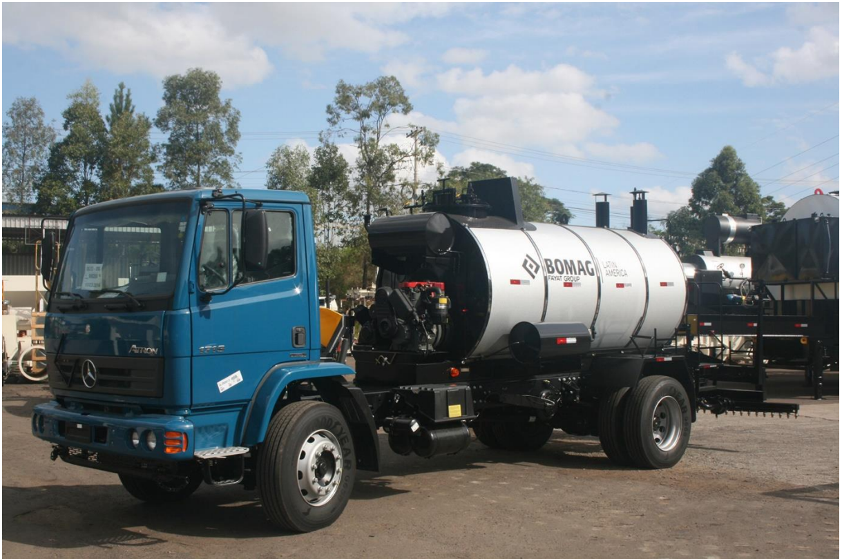
Figura 6: Caminhão distribuidor de asfalto
