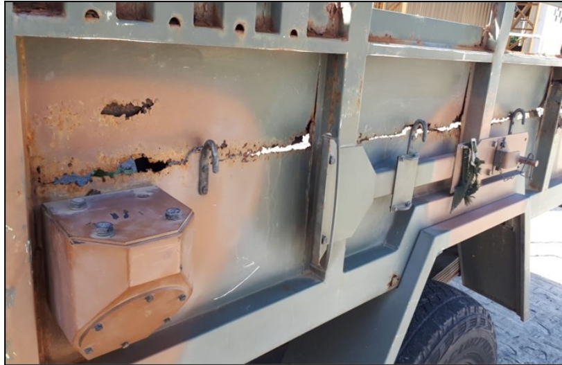
Figura 2: Viatura Marruá AM21(corrosão excessiva)
