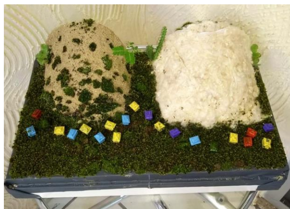
Figura 7: Maquete de testes de hidrofobicidade da paina e sua eficiência. Fonte: AUTORES (2019).
