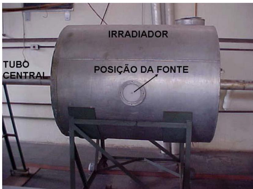
FIG 1.2: Irradiador do IPEN, utilizado para a determinação de elementos inorgânicos em fertilizantes comerciais. (Maddi Filho, 2005)
