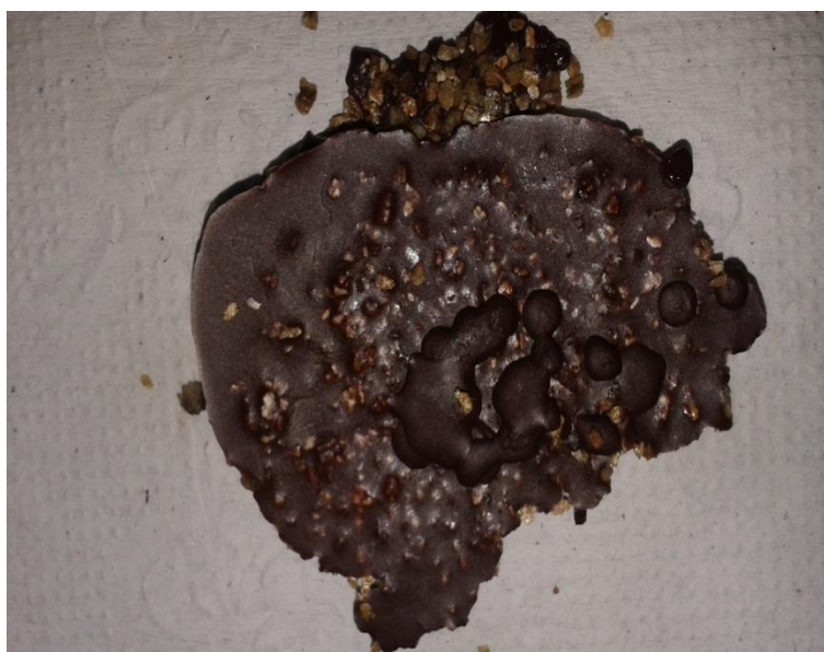
Figura 5.12 Agregado de 13%p de ferrita de níquel-zinco com vermiculita pura
