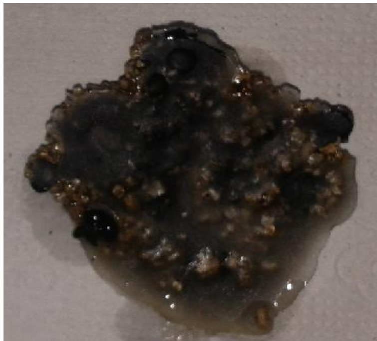
Figura 5.6 Agregado de 13%p de ferrita de cobalto com vermiculita hidrofobizada.
