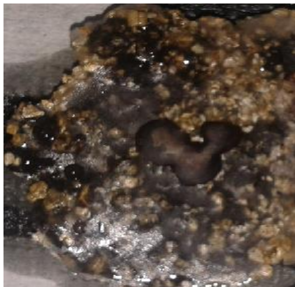
Figura 5.8 Agregado de 13%p de ferrita de níquel com vermiculita pura
