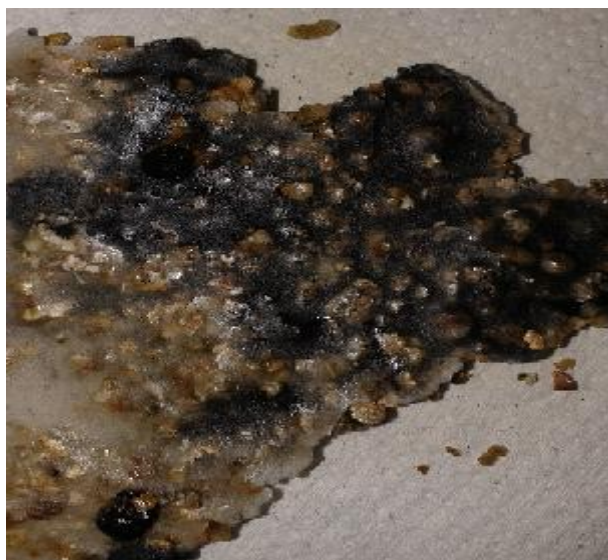
Figura 5.4 Agregado de 13%p de ferrita de cobalto com vermiculita pura.
