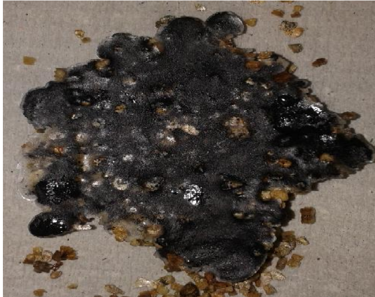
Figura 5.5 Agregado de 28,5%p de ferrita de cobalto com vermiculita pura.
