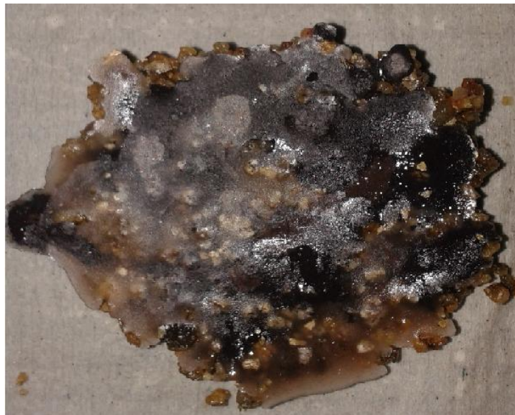
Figura 5.11 Agregado de 28,5%p de ferrita de níquel com vermiculita hidrofobizada.
