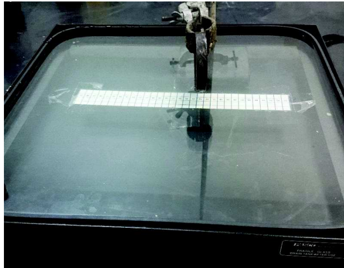
FIG. 4.4 Tanque de ondas com escala milimetrada e ímã posicionados para o arraste.
