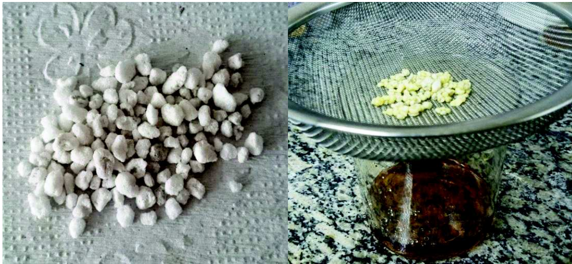
FIG. 4.1 – (a) Perlita peneirada usada para sorção e (b) perlita impregnada com óleo.
