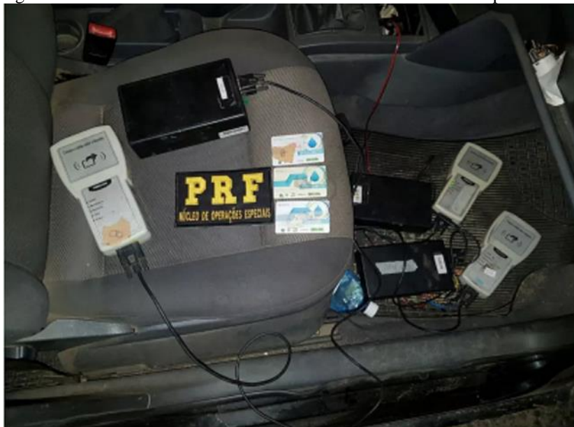
Figura 03 – Módulos Embarcados de Monitoramento em carro de passeio
