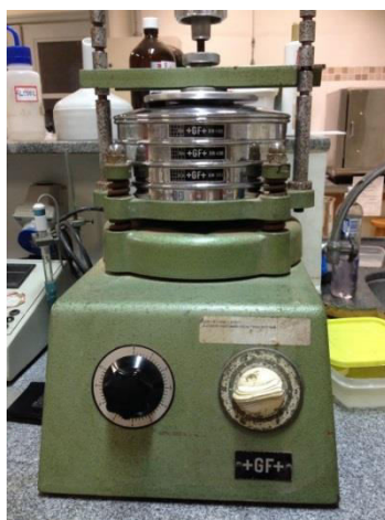
FIG 5.8. Granulômetro com 3 faixas de granulometria
