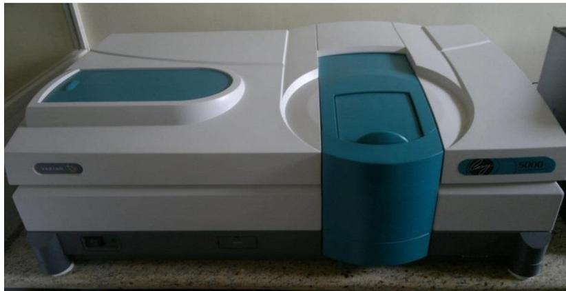
FIG. 4.6 Foto do Espectrofotômetro Cary 5000.
