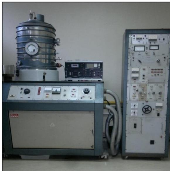
FIG. 4.1 Evaporadora da Edwards, modelo 19A
