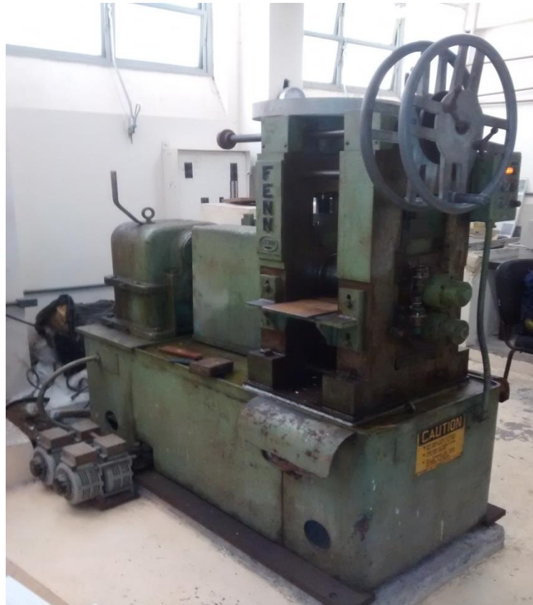
Fig 9: Laminador FENN do Laboratório de Processamento Mecânico.
