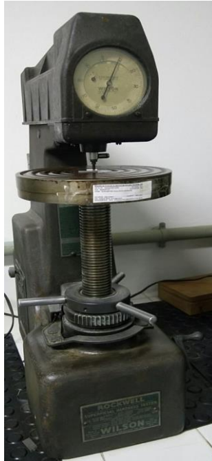
Fig 13: Durômetro superficial (fabricante WILSON, modelo 3JS).
