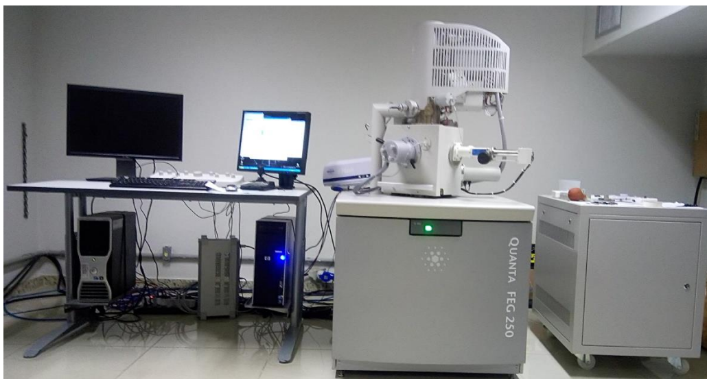
Fig 16: Microscópio eletrônico de varredura modelo Jeol QUANTA 250 FEG fabricante FEI.
