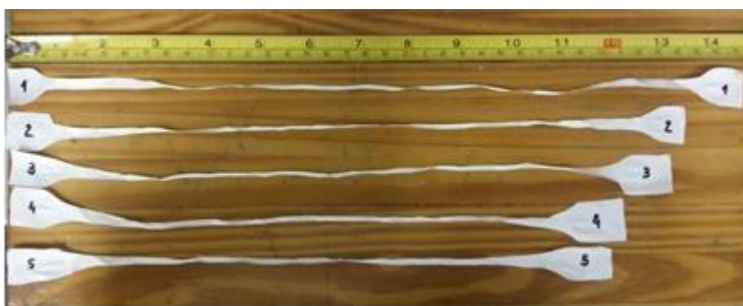
Figura 29 - Grupo de amostras do e-PTFE (membrana) após os ensaios de tração.
