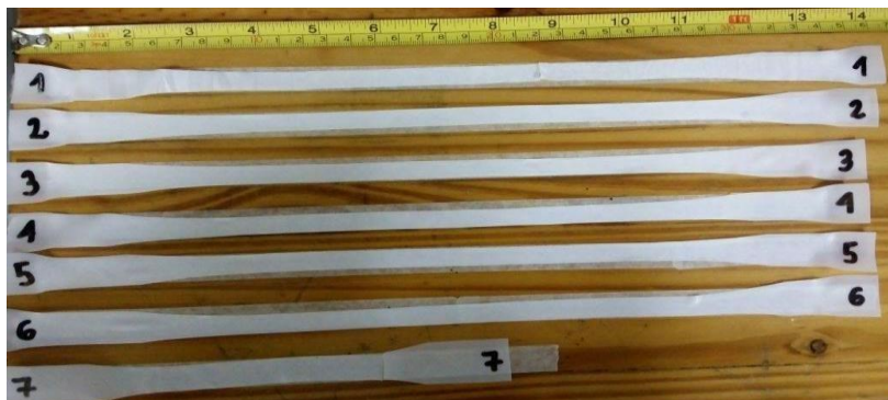
Figura 28 - Grupo de amostras do PTFE laminado (barreira) após os ensaios de tração.
