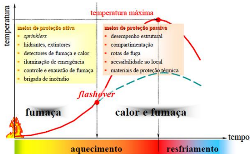
FIG. 2.5 Desempenho dos meios de proteção no comportamento do incêndio real.
