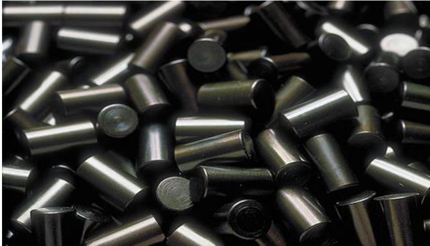
FIG. 1.3 Pastilha combustível de Dióxido de Urânio (ULMER-SCHOLE, 2017)
