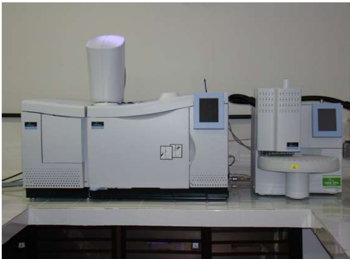
FIG. 3.1 Cromatógrafo a gás e extrator de headspace (fonte: Perkin Elmer).
