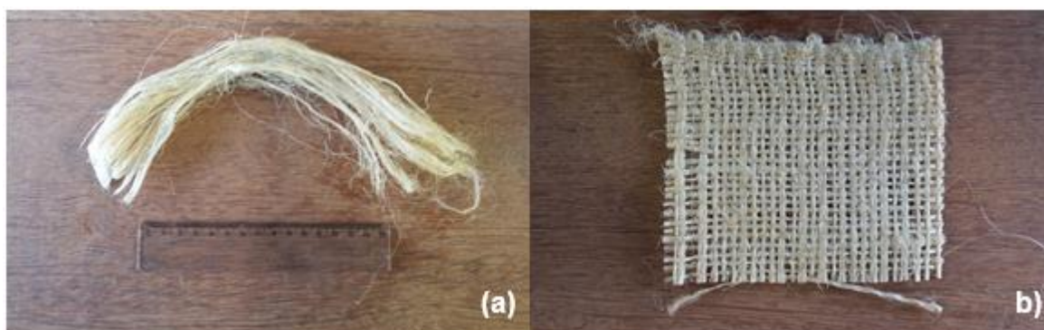
FIG. 3.1: Fibras de fique: (a) fibras separadas; (b) tecido com trama simples (entremeado ortogonal e alternado).
