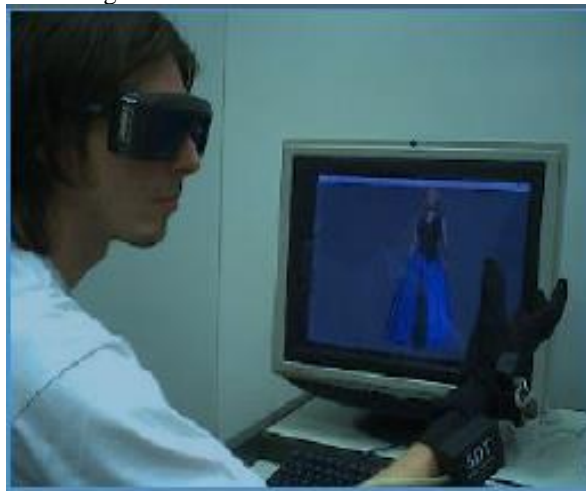
Figura 3 – RV não imersiva com monitor
