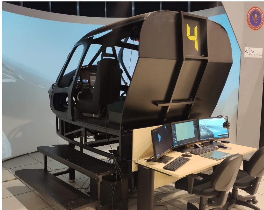
Figura 2 – Cabine atual do Flight Training Device (FTD) da Divisão de Simulação do CIAvEx.
