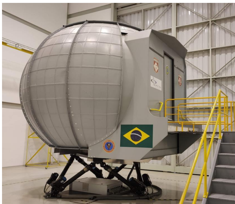
Figura 3 – Simulador de Helicópteros Esquilo-Fennec (SHEFE) da Divisão de Simulação do CIAvEx.
