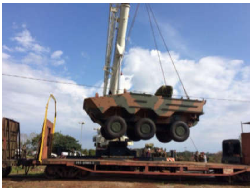
Figura 18 – Içamento da VBTP MSR GUARANI e gabarito da ferrovia
