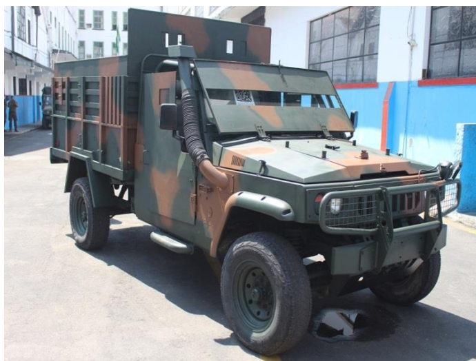
Figura 2: Viatura Marruá com Blindagem adaptada pelo AGR
