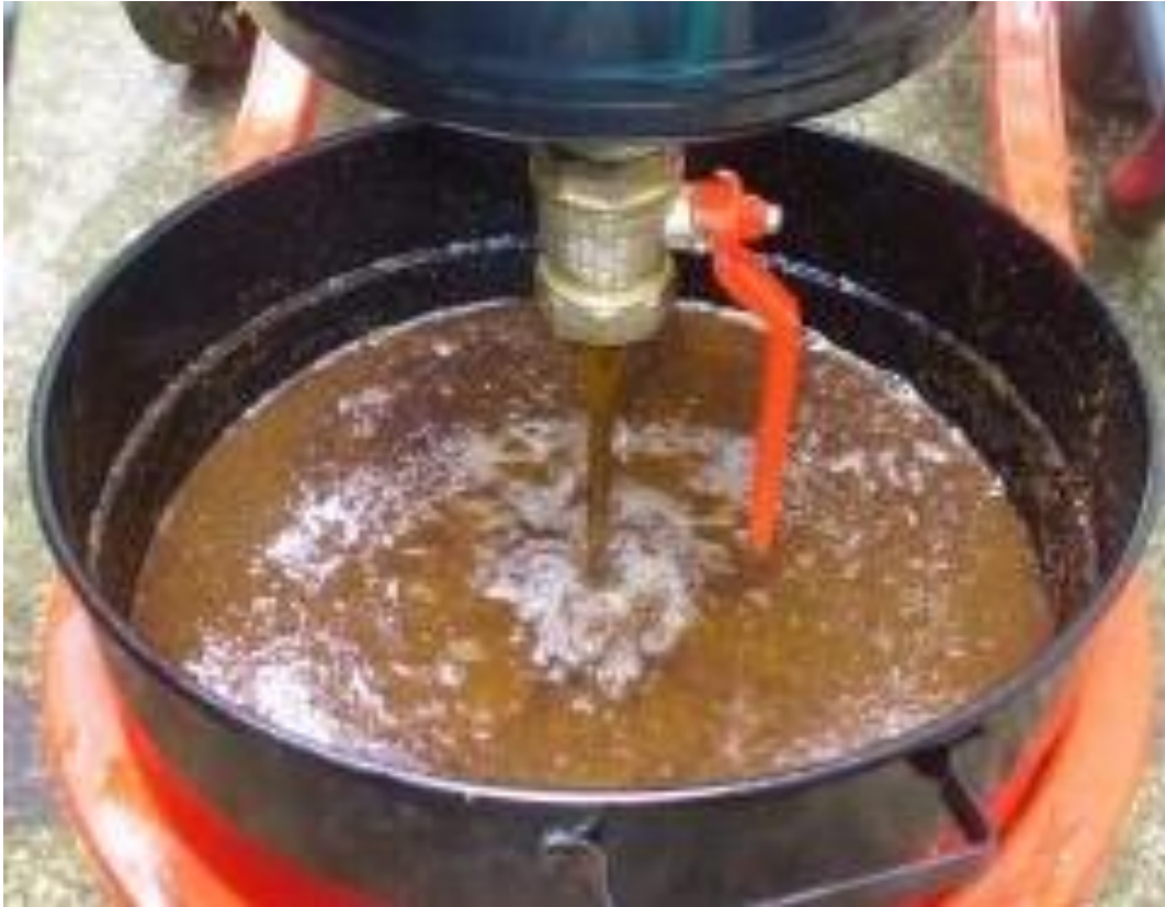
Figura 6: Resíduo não solúvel de posto de abastecimento após Diesel tratado Fonte: BRASILPOSTOS, 2014
