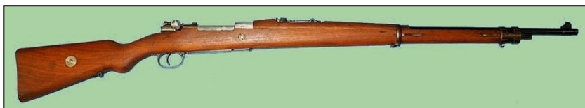
Figura 1 – O fuzil Mauser “brasileiro” Modelo 1908, em calibre 7x57mm, modelo 1898, importado da D.W.M. e conhecido aqui como F.O. 08, Fuzil Ordinário “zero-oito”.
