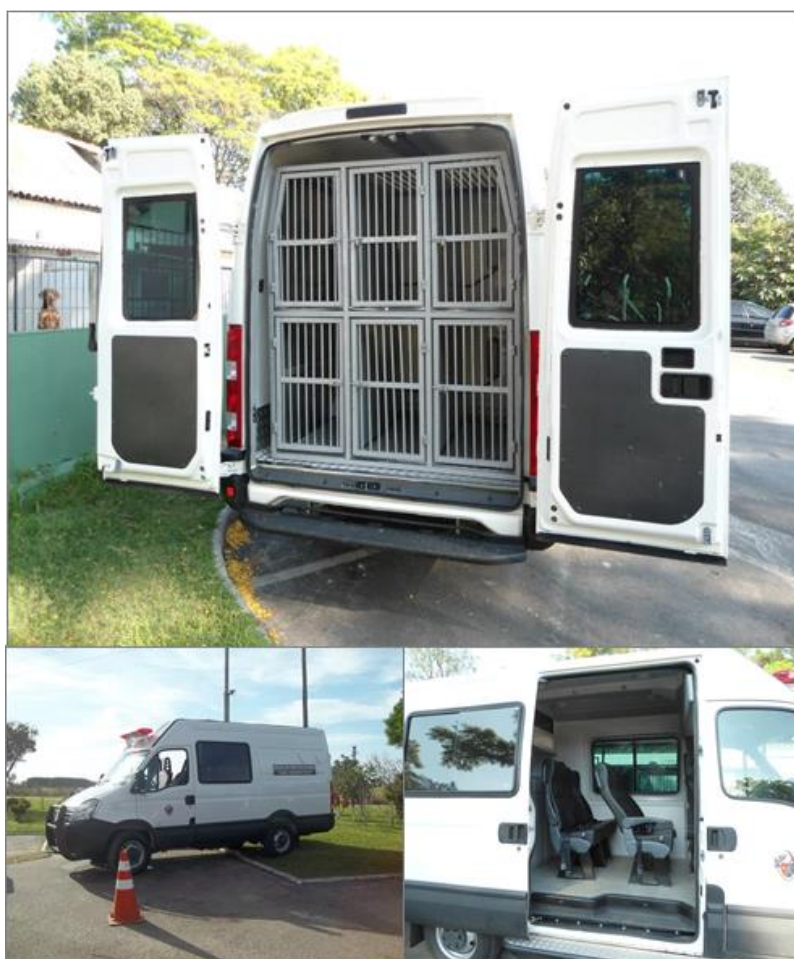
Figura 5. Viatura Especializada de Transporte de Cães. Padrão adotado pelo Exército Brasileiro com seis boxes para cães, oito assentos para condutores e local de acondicionamento de medicamentos e equipamentos veterinários. Fonte: Soares (2013).
