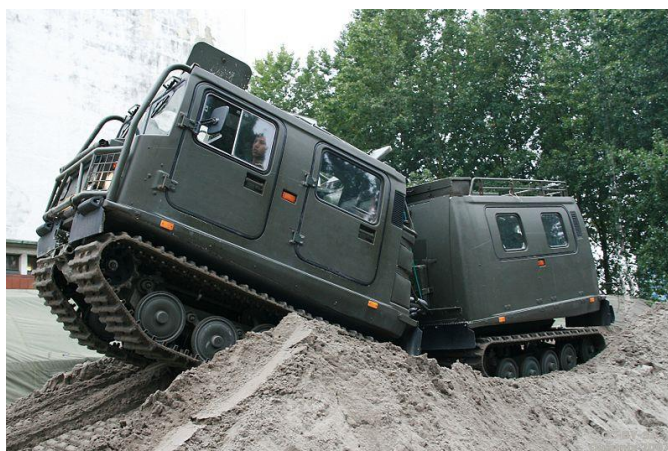
Fig. 2 Tratores Oruga Bv 206, com capacidade de rebocar um canhão de 105 mm e transportar até 7 militares.
