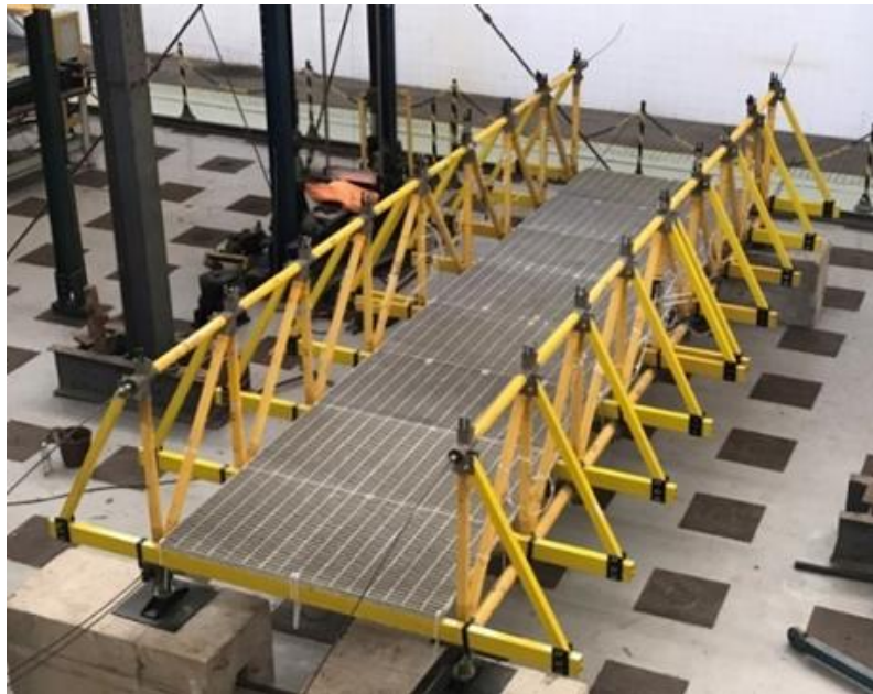
Figura 34 – Ponte do modelo reduzido montada Fonte: DINIZ, 2018
