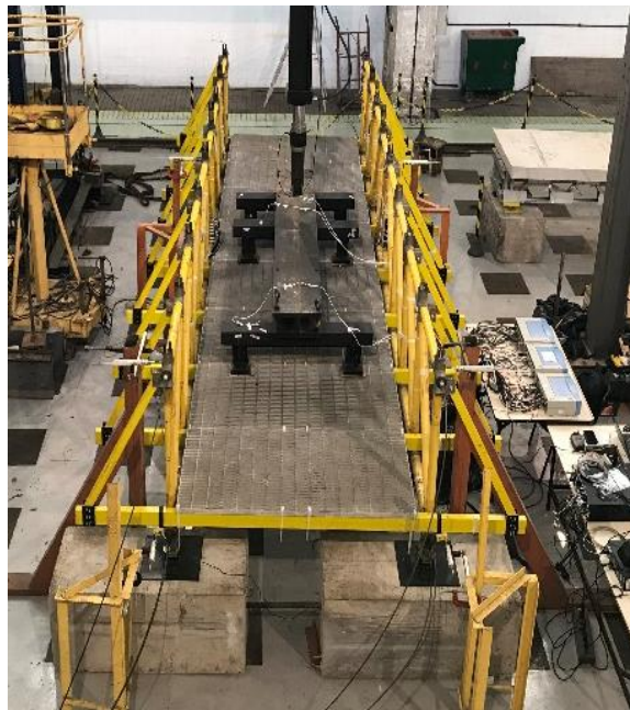
Figura 38 – Estrutura de carregamento posicionada sobre a ponte Fonte: DINIZ, 2018
