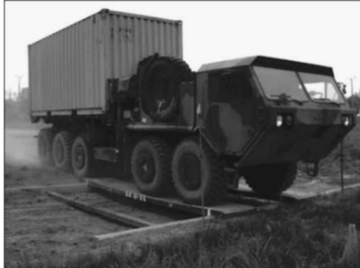
FIGURA 19 – Passagem de um veículo de classe MLC 30 sobre o pontilhão Fonte: M. J., R., & J. B., 2008
