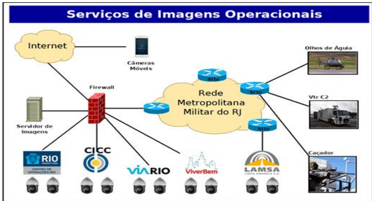
FIGURA 11 – Infraestrutura da rede das câmeras, excetuando os serviços da Supervia e do Metrô-Rio. Fonte: O autor, com base nas informações do B Es Com e do 2ºCTA.
