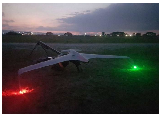
Figura 5 – SARP Orbiter 3 em sua estrutura de lançamento
