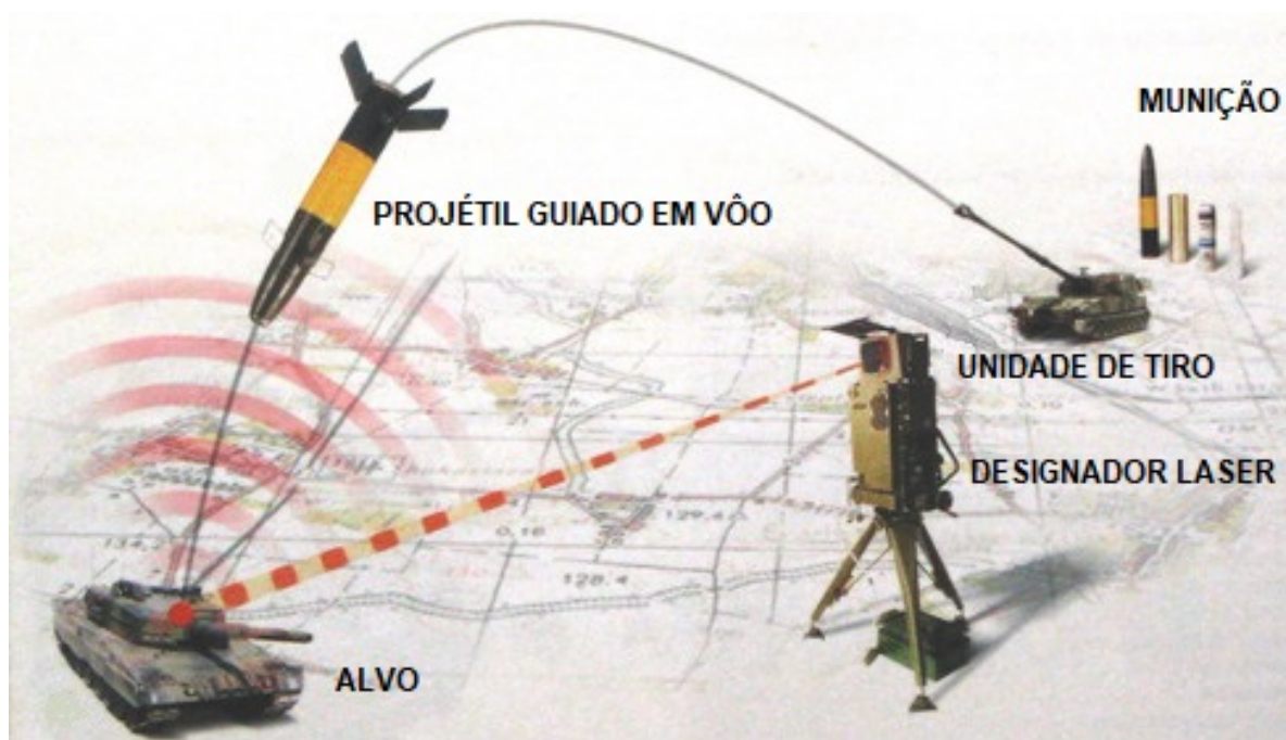
FIGURA 2 – Sistema de guiamento à laser
