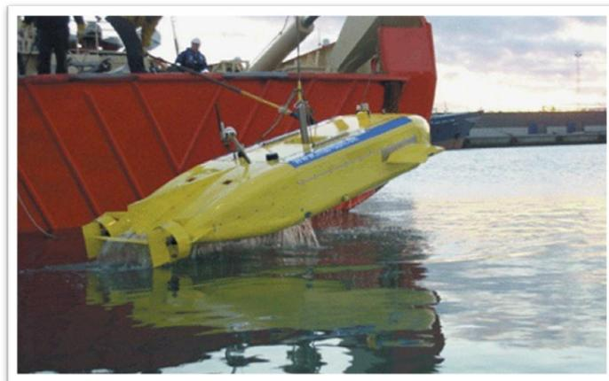
Figura 4.4: Protótipo de veículo submarino não tripulado utilizando células a combustível.
