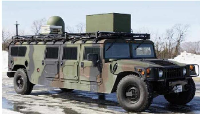
Figura 4.2: Protótipo de veículo de comando e controle com unidade geradora de energia de 2 kW a célula a combustível.
