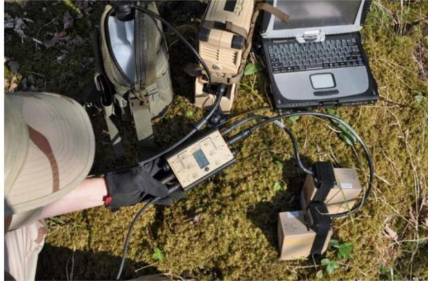
Figura 4.4: Célula a combustível JENNY 1200 associada a um gerenciador que fornece energia para um laptop e baterias e um cartucho de metanol.
