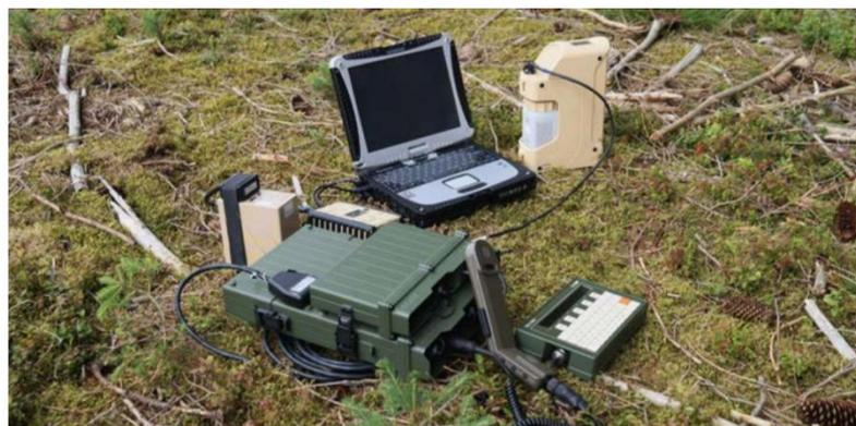
Figura 4.5: Célula a combustível JENNY 600S fornecendo energia para um sistema rádio e um computador.
