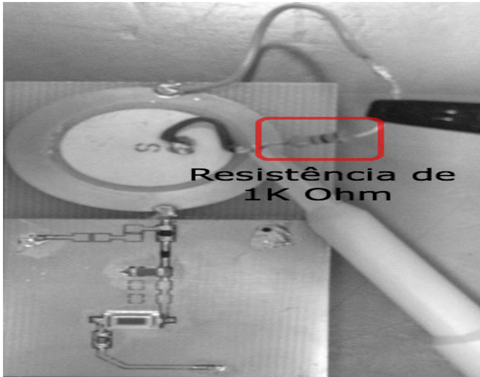
FIG. 6.2: Medida preliminar do perfil de tensão gerado pelas pastilhas piezelétricas
