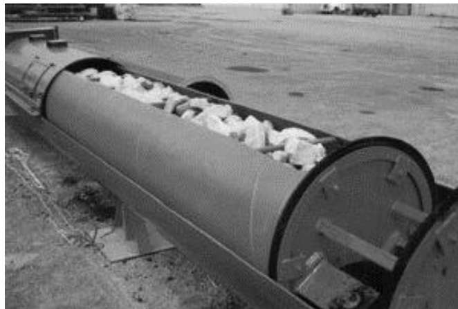
FIG. 2.3 Protótipo de PCP para transporte de brita em Ontário, Canadá. (fonte: www.capsu.org )
