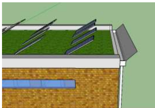
Figura 28 - Sistema Acoplado ao Telhado para Coleta de Água.
