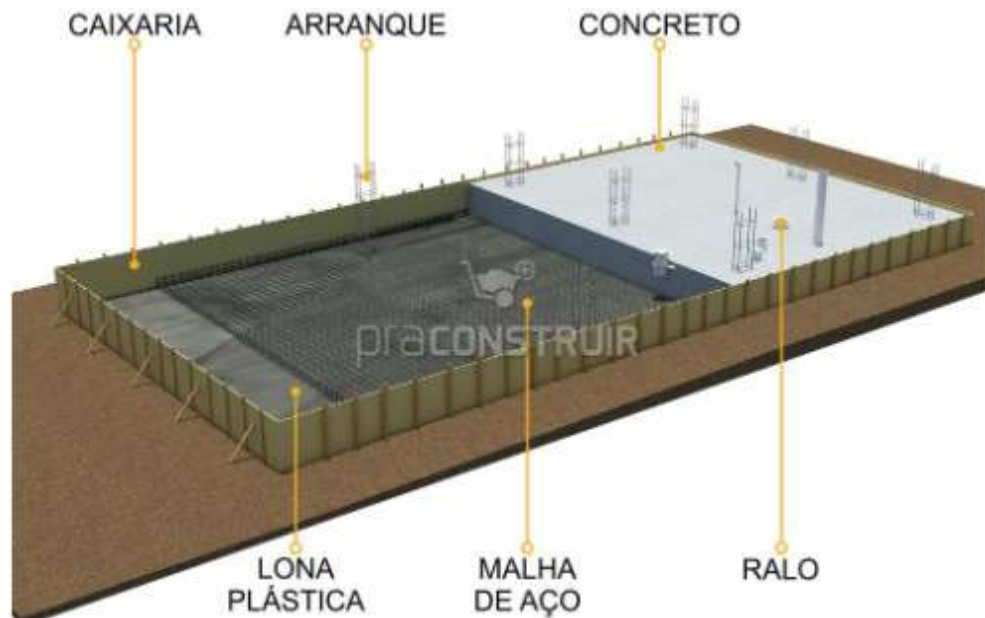
Figura 23 - Fundação em Radier ( http://blogpraconstruir.com.br/etapas-da-construcao/radier/ )
