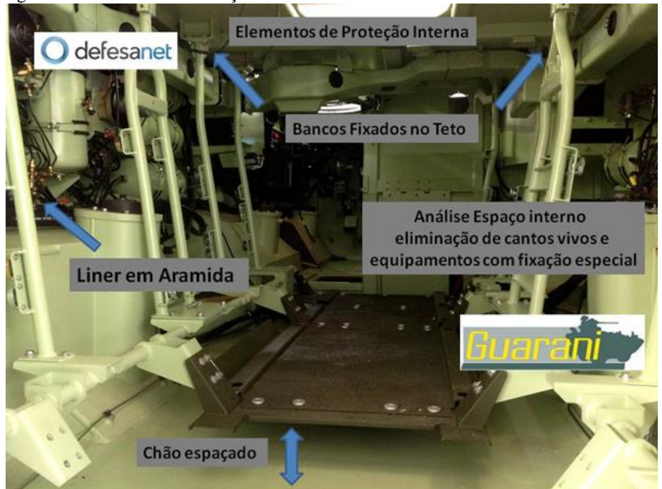
Figura 2 – Elementos de Proteção Interna
