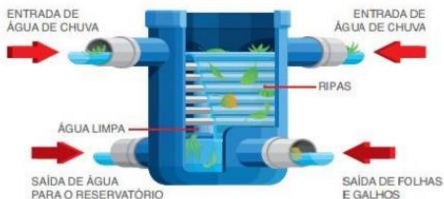
Figura 14 - Filtro para retenção de sólidos.
