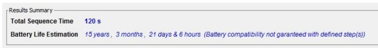
Figura 4.8: Duração estimada para a bateria CR2032 e alerta de incompatibilidade com o projeto
