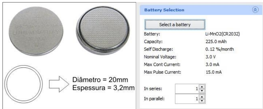
Figura 4.7: Principais parâmetros técnicos do modelo de bateria CR2032
