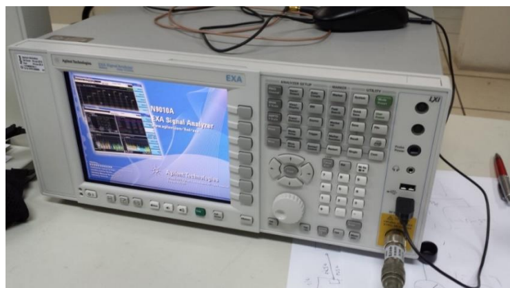
Figura 4.12: Medição com o Analisador de Sinal N9010 EXA da Agilent Technologies
