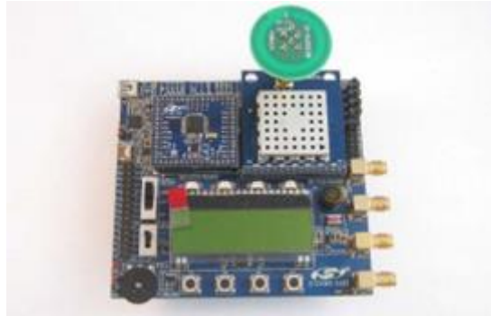
Figura 3.10: Configuração de medição dos parâmetros de uma antena da família estudada
