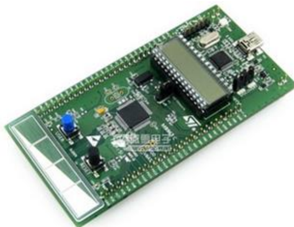
Figura 3.4: Placa de desenvolvimento do microcontrolador STM32L152RCT6
