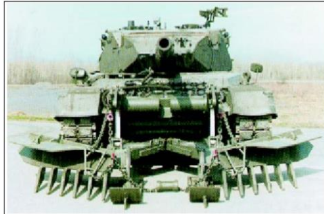
Figura 3 – Carro de combate pesado equipado com Arado Removedor de Minas
