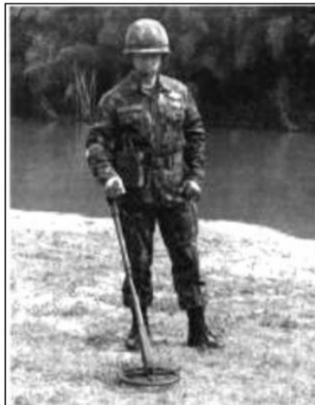
Figura 2 – Soldado em adestramento usando o detector de metais DM 1000
