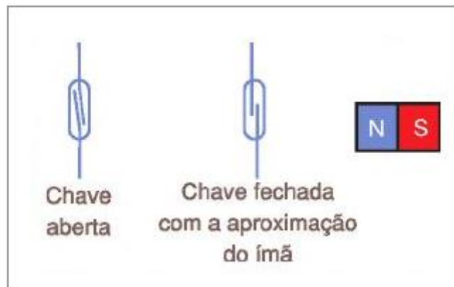
Figura 4 - Funcionamento do reed-switch
