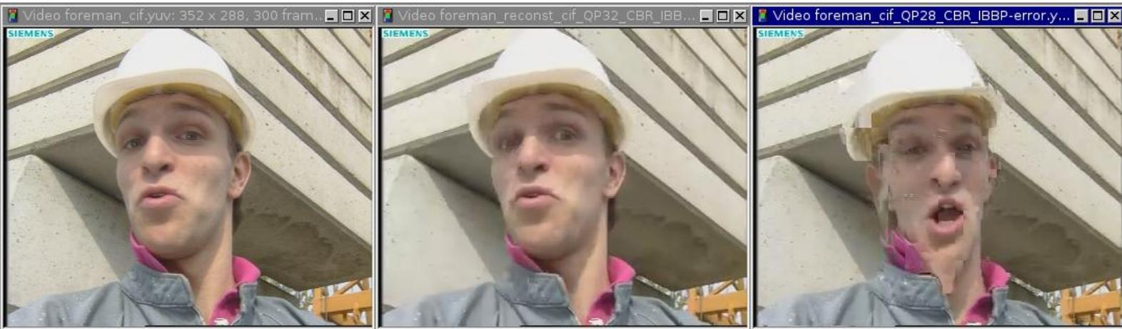
**FIGURA 3** O mesmo quadro, da esquerda para a direita, em vídeo bruto, em vídeo com codificação CBR, GOP IBBP e QP de frame "I" de 32 com perdas visíveis devido à quantização e vídeo codificado com QP de quadro "I" de 28, melhor qualidade de codificação, mas sofrendo os efeitos de uma perda de pacote.
