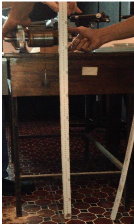
FIG 4.7 - Ensaio para determinação do momento de inércia.
