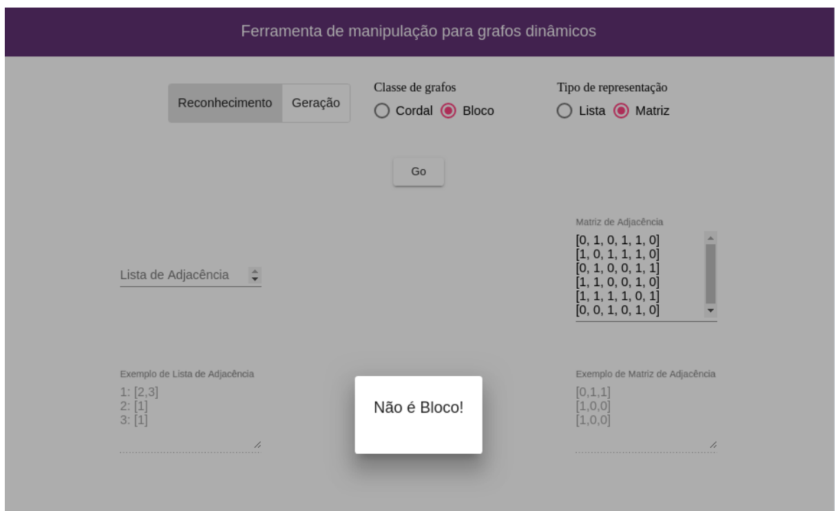
FIG. 4.13: Página de reconhecimento de um grafo não bloco representado como matriz de adjacência
