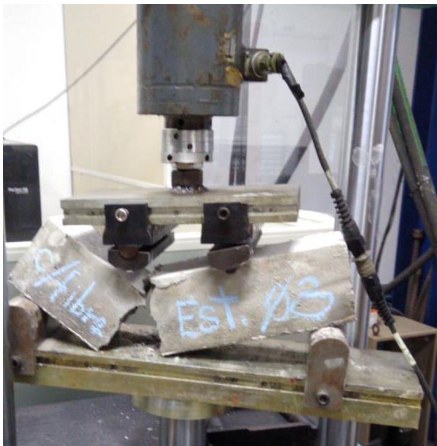
FIG. 7.6 – Corpo de prova de concreto com fibras de aço após sua ruptura por flexão.
