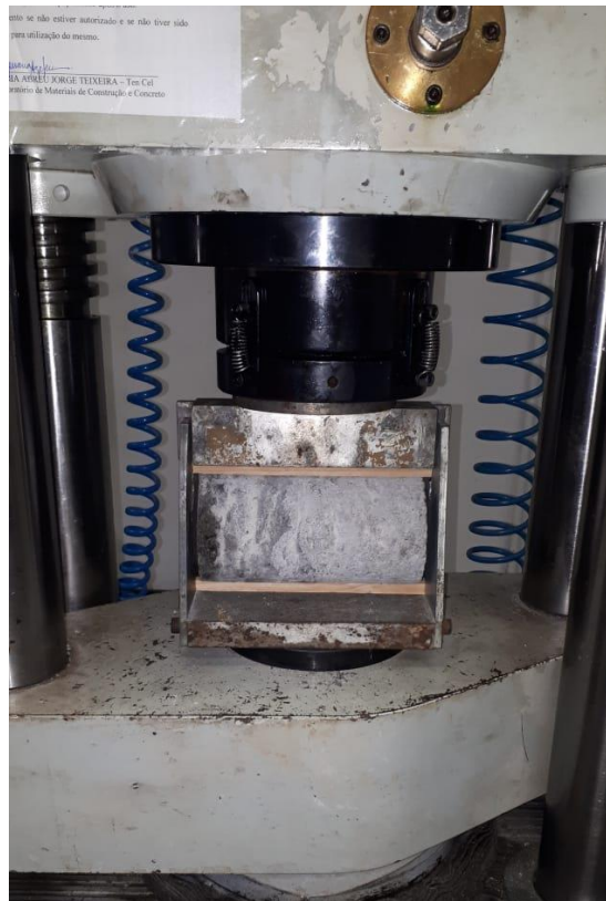
FIG. 6.5 – Ensaio de resistência à tração por compressão diametral.
