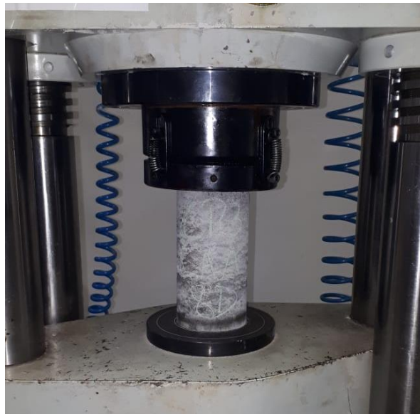
FIG. 6.4 – Prensa de 1000 kN de capacidade com corpo de prova de concreto
