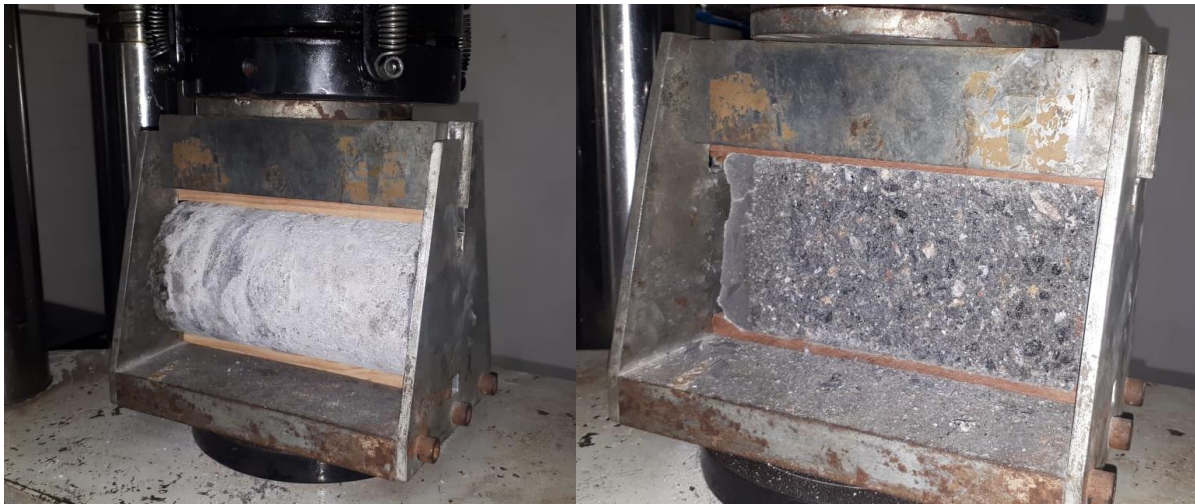
FIG. 7.3 – Corpos de prova de concreto sem fibras após sua ruptura por compressão diametral
