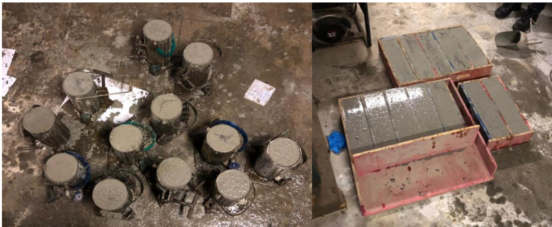
FIG. 6.2 – Fôrmas metálicas para os corpos de prova cilíndricos (à esquerda) e de madeira para os prismáticos (à direita).
