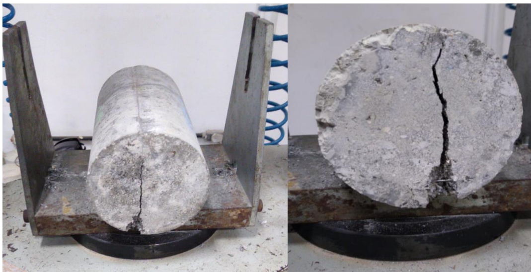
FIG. 7.4 – Corpos de prova de concreto com fibras de aço após sua ruptura por compressão diametral.
