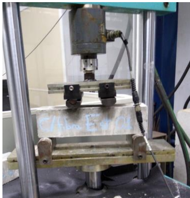
FIG. 6.7 – Ensaio de resistência à tração na flexão
