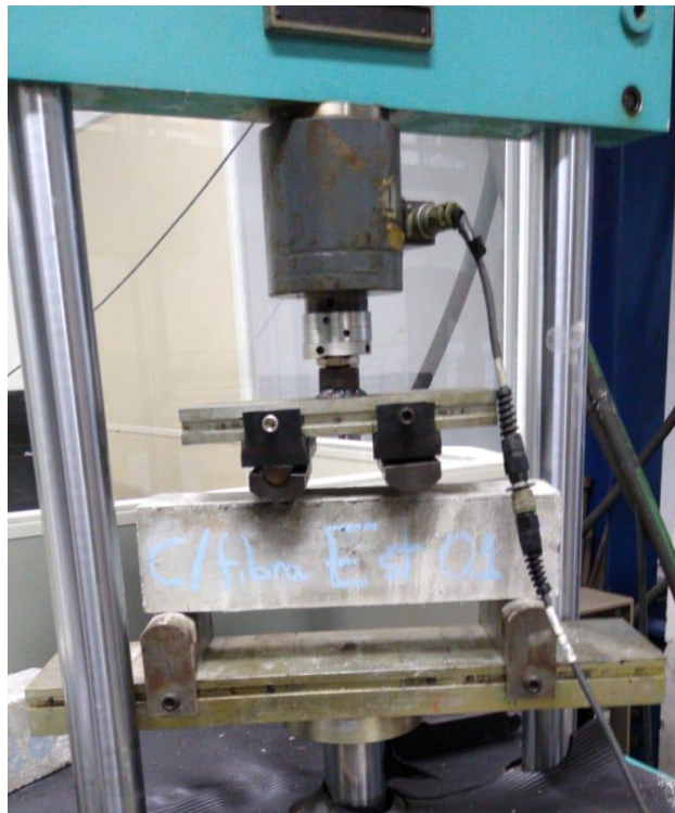
FIG. 6.8 – Ensaio de fadiga à flexão.
