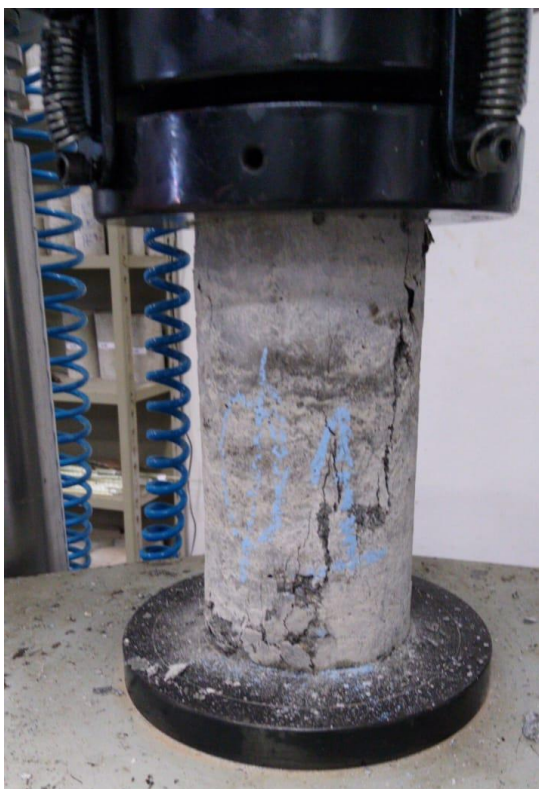
FIG. 7.1 – Corpos de prova de concreto sem fibras de aço após sua ruptura por compressão
