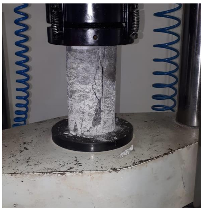
FIG. 7.2 – Corpos de prova de concreto com fibras de aço após sua ruptura por compressão
