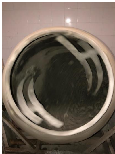
FIG. 6.3 – Betoneira de 320 litros usada na concretagem
