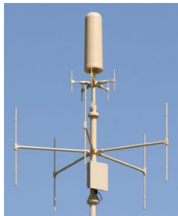
Figura 14 – Antena DF e Monitoramento V/UHF
