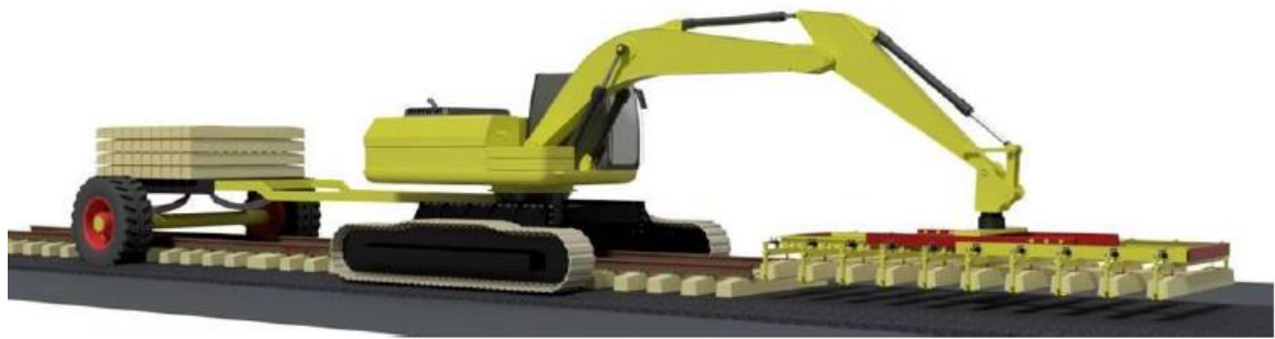
Figura 32 - Escavadeira adaptada para a retirada dos dormentes (LOPES, 2017)
