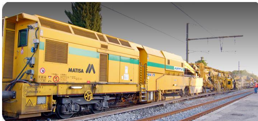
Figura 8 - Máquina P190 (Marca Matisa) para substituição de dormentes e trilhos (Fonte: QUIRINO, 2010)
