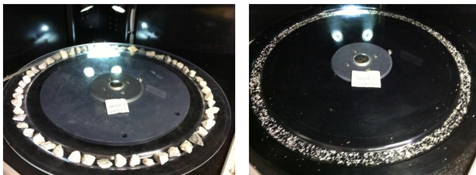
FIG. 3.3 Agregados dispostos nas bandejas circulares do equipamento AIMS.
