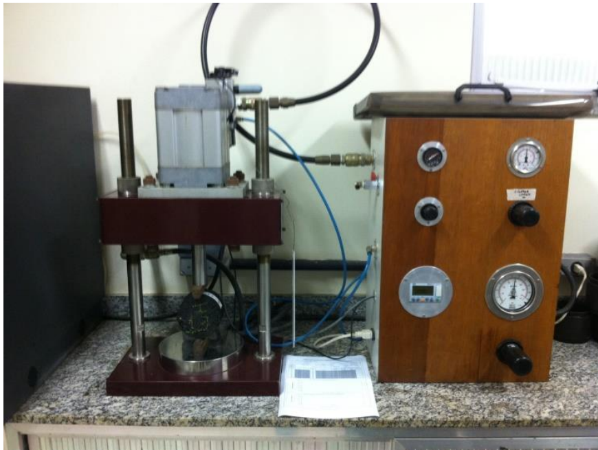
FIG. 3.9 Equipamento para ensaio de fadiga do IME, utilizado nesta pesquisa.
