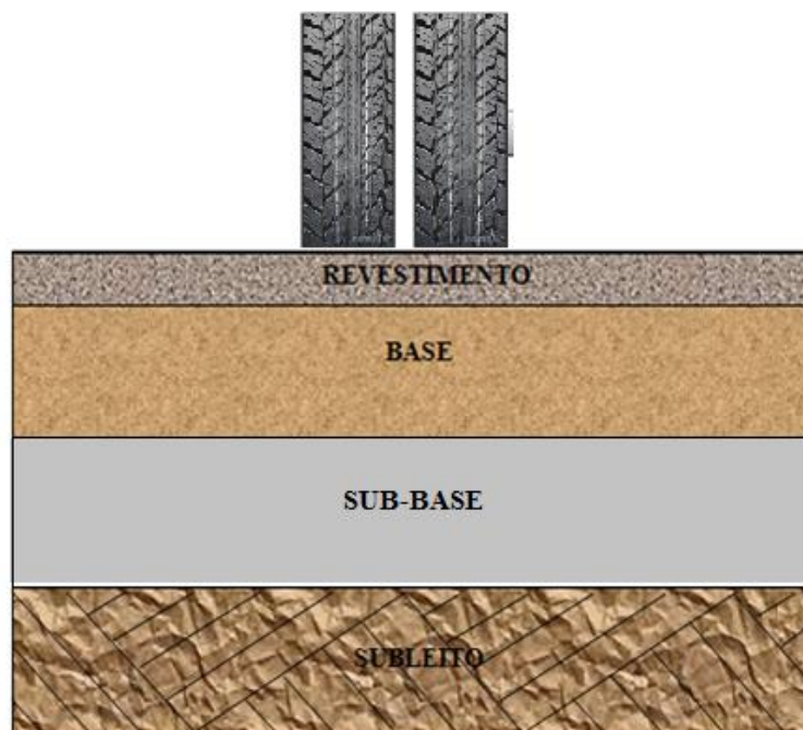
FIG. 4.8 Estrutura do pavimento simulado na comparação das misturas.
