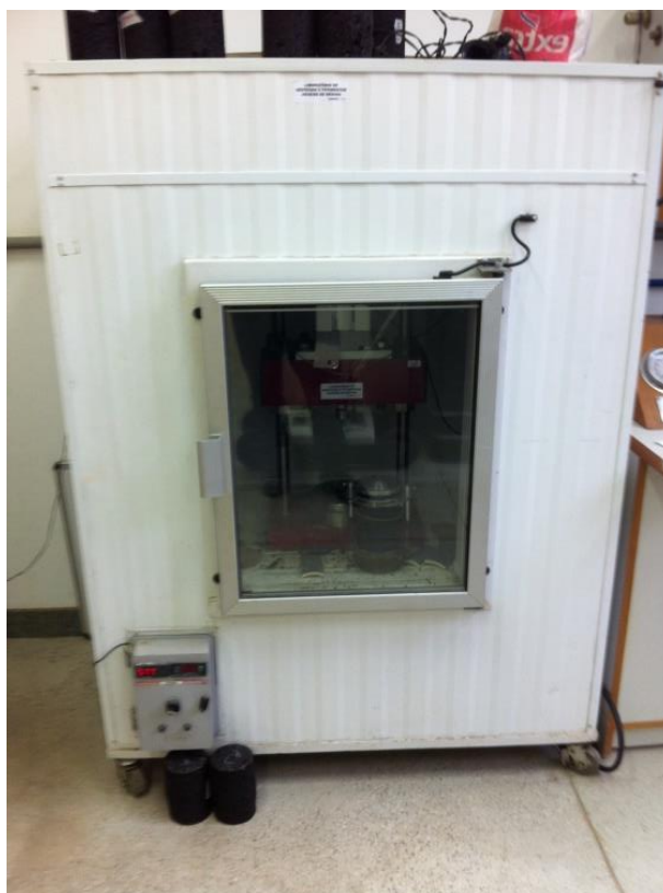
FIG. 3.10 Equipamento do ensaio de cargas repetidas de FN.
