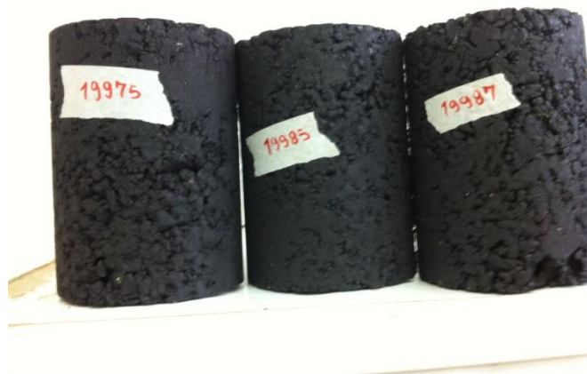
FIG. 3.11 Corpo de prova após o ensaio de Flow Number com 7% Vv.
