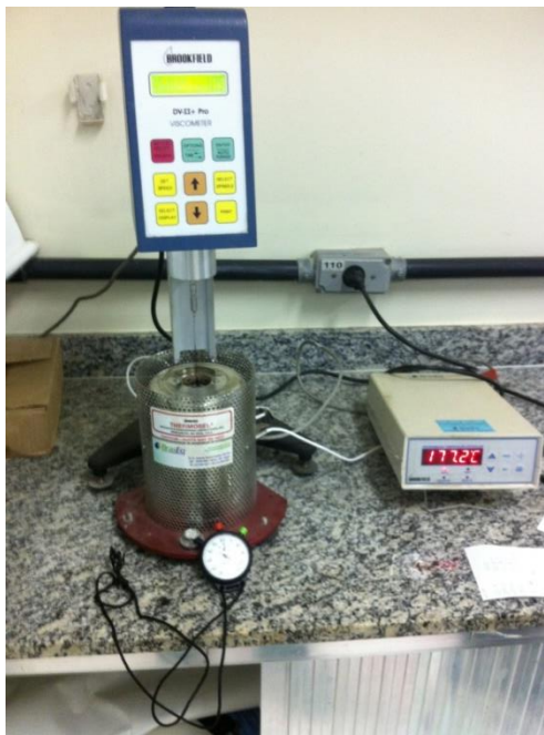
FIG. 3.4 Equipamento Brookfield utilizado nesta pesquisa.
