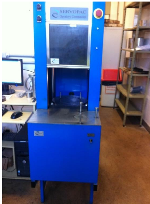
FIG. 3.6 Compactador giratório Superpave (CGS) COPPE/UFRJ.
