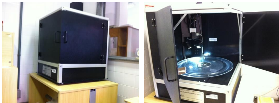
FIG. 3.2 Equipamento AIMS utilizado na pesquisa.
