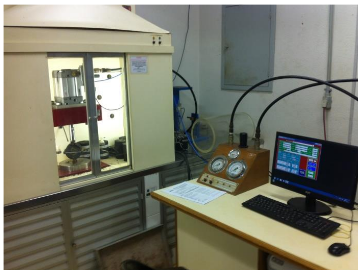
FIG. 3.7 Equipamento para ensaio de MR do IME, utilizado nesta pesquisa.
