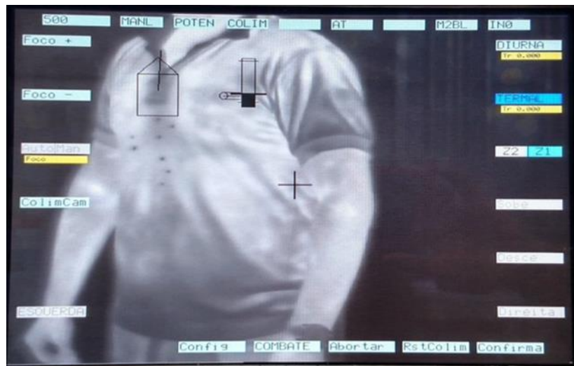
Figura 4: Display Multifunção, com imagem térmica (IT) realizada pela câmera termal
