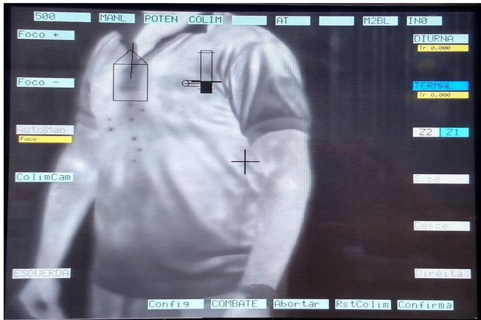
Figura 11: Display Multifunção, com imagem térmica (IT) proveniente da observação realizada pela câmera termal.
