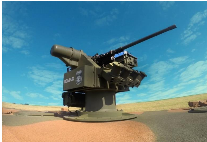
Figura 8: Torre REMAX com o seu Módulo Optrônico a direita da Mtr 50 M2 HB Fx Browning e lançadores de granadas fumígenas ao centro.
