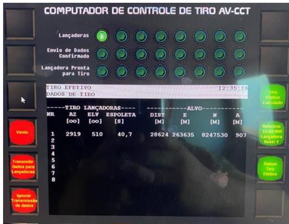
Figura 13- Elementos de Tiro calculados pelo método eletrônico. Fonte: O autor.
