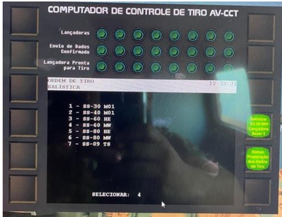
Figura 12- Escolha do foguete SS-60 MW no software CCT. Fonte: O autor.
