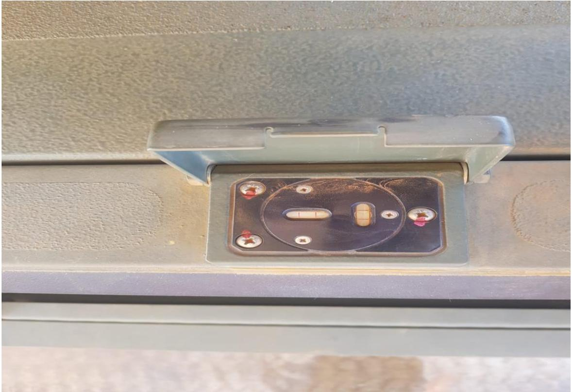
Figura 7 – Bolhas de nivelamento VBUFC MK6
