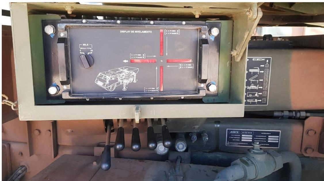
Figura 8 – Display de nivelamento da VBLMU MK6
