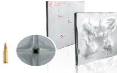
Figura 10: Impacto nas placas de proteção balística
