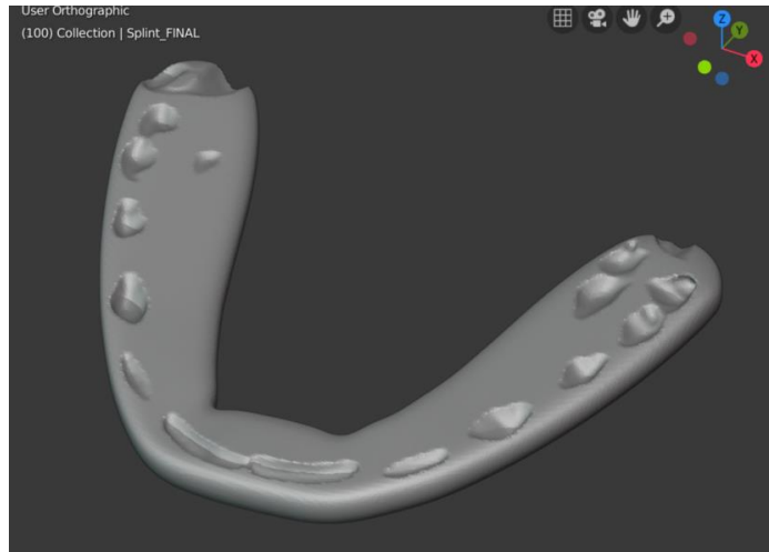
FIGURA 21 - Guia cirúrgico com os sulcos gerados em função da posição virtual dos dentes Fonte: Arquivo pessoal do autor.
