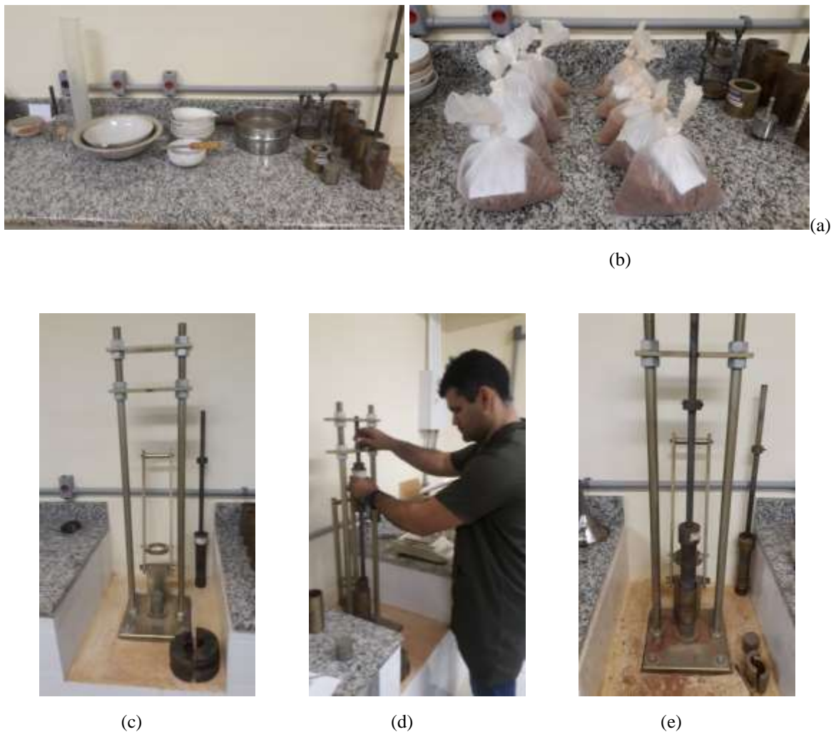
Figura 3.9 Ensaio de compactação Mini-MCV no IME: a) Aparelhagem; b) Amostras preparadas; c) Compactador; d) Aferição; e) Compactação
