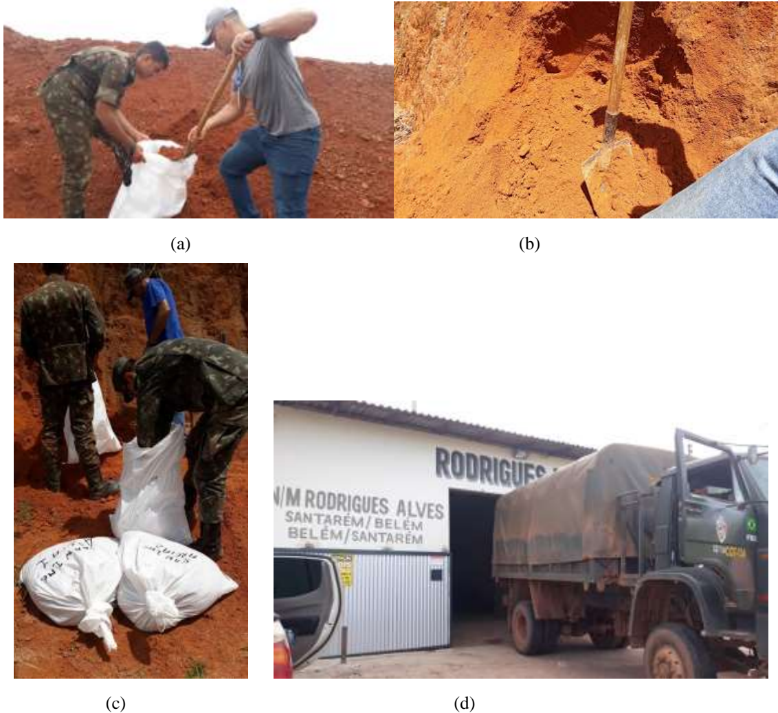
Figura 3.7 Coleta e transporte de amostras: a) Laterita; b) Solo fino; c) Acondicionamento; d) Transporte de Santarém para Belém
