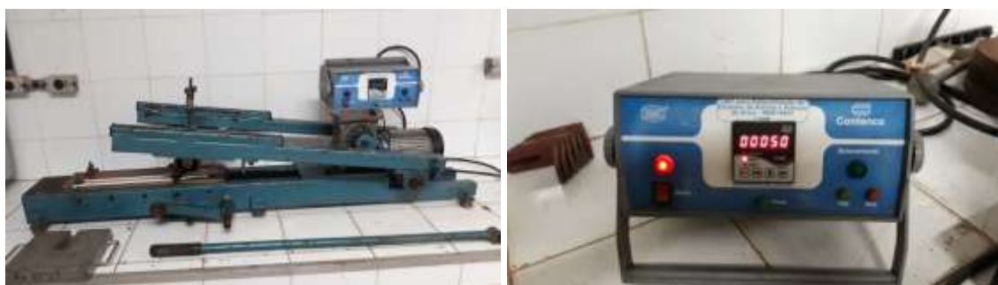
Figura 3.15 Equipamento LWT utilizado na pesquisa: a) Vista geral; b) Controlador de ciclos
