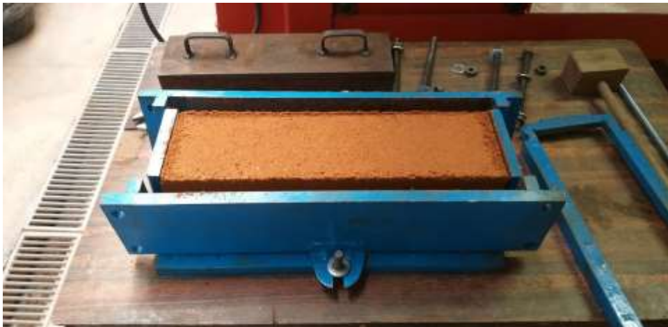
Figura 4.20 Molde do corpo de prova utilizado na segunda fase dos ensaios LWT.
