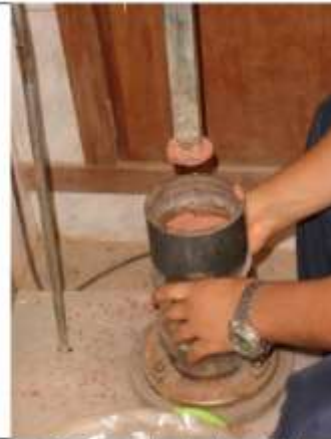
2 - Compactação da penúltima camada com anel complementar.
