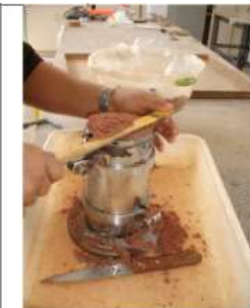
4 - Rasando o corpo de prova após a retirada do colarinho
